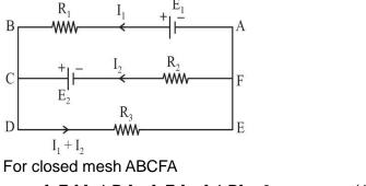
$[+E_1] [-I_1R_1] + [-E_2] + [+I_2R] = 0 \qquad \dots (1)$
